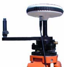
Permitir la inicialización cinemática empleando la barra inicializadora en la base
