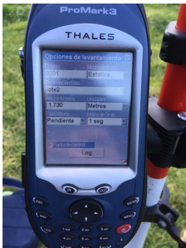
Imagen N.5 “Configuración del receptor base para el levantamiento Stop and go”
