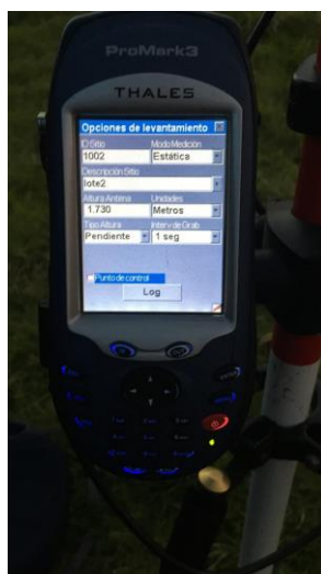
Imagen N.3 “Configuración del receptor remoto para el levantamiento Estático”
