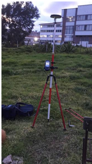
Imagen N.1 “Montaje de la base para el levantamiento Estático”
